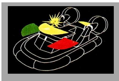
Ein Luftkissenfahrzeug in Fahrt führt dieselben Lichter wie ein Maschinenfahrzeug und zusätzlich ein gelbes Rundum-Funkellicht.
