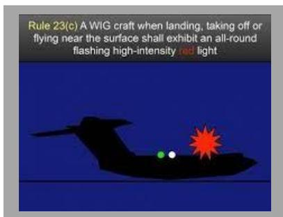
Ein Bodeneffekt-Luftfahrzeug führt dieselben Lichter wie ein Maschinenfahrzeug, solange es Wasser-berührung hat. Sobald es abhebt, fliegt oder landet muss es zusätzlich ein rotes Rundum-Funkellicht führen.
