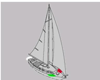
Segelschiffe unter Segeln führen Seitenlichter und ein Hecklicht, aber kein Topplicht (wie Ruderboote und geschleppte Fahrzeuge). Segelfahrzeuge, die unter Motor fahren, gelten als Maschinenfahrzeuge und führen entsprechend auch ein Topplicht – dies ist wichtig, da Segelfahrzeuge gegenüber den meisten Maschinenfahrzeugen Vorfahrt haben, was sich bei Fahrt unter Motor wieder verändert.
