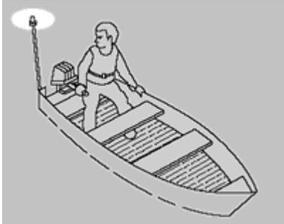
Ein Maschinenfahrzeug von weniger als 7 m Länge, dessen Höchstgeschwindigkeit 7 kn nicht übersteigt, darf statt Topp-, Heck- und Seitenlichtern ein weisses Rundumlicht und muss, wenn möglich, ausserdem Seitenlichter führen.
