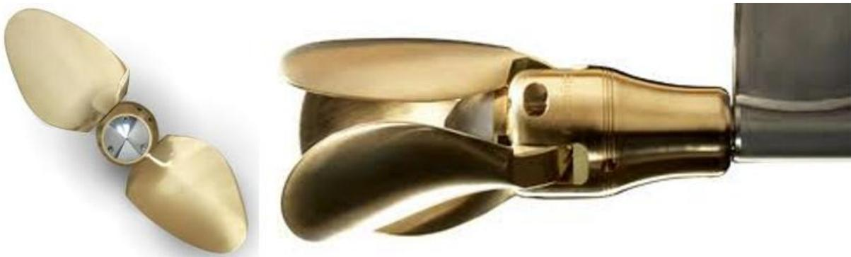
Ist es sogar möglich, die Flügel zu drehen, kann man, ohne die Maschine rückwärts laufen zu lassen, von der Vorwärts- in die Rückwärtsfahrt wechseln.
