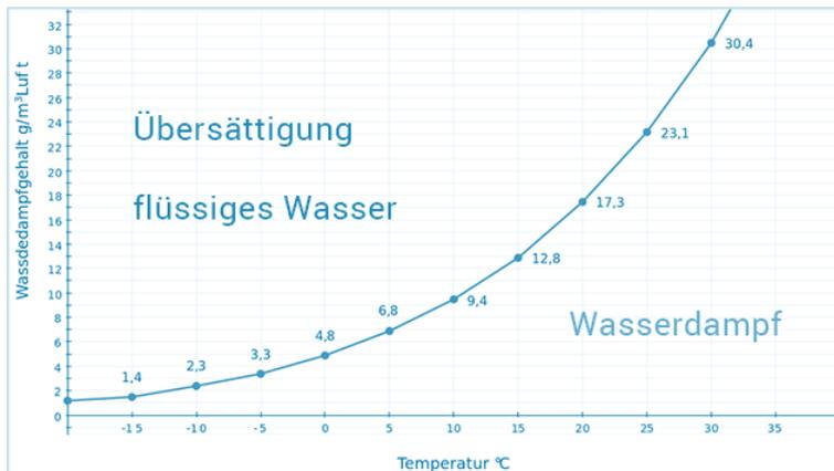
In der obigen Sättigungsdampfkurve ist erkennbar, dass der Sättigungsdampfdruck bei einer Temperatur von  $-10^{\circ}\text{C}$   $2,9\text{ hPa}$  beträgt; bei einer Temperatur von  $+25^{\circ}\text{C}$  liegt er bei  $31,6\text{ hPa}$ . Das bedeutet, dass die warme Luft rund das 10fache an Wasserdampf aufnehmen kann.
