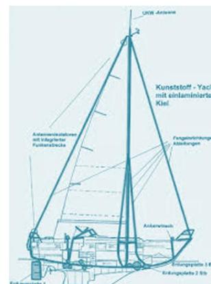
Im Gegensatz zu Grossyachten, die aufgrund der Bauvorschriften standardmässig mit einem Schutzsystem ausgestattet sind, ist dies bei Yachten im Serienbau nicht üblich. Ein Blitzschutz kann den Einschlag nicht verhindern, aber den Einschlagpunkt und den Weg des Blitzstroms ins Wasser kontrollieren.
